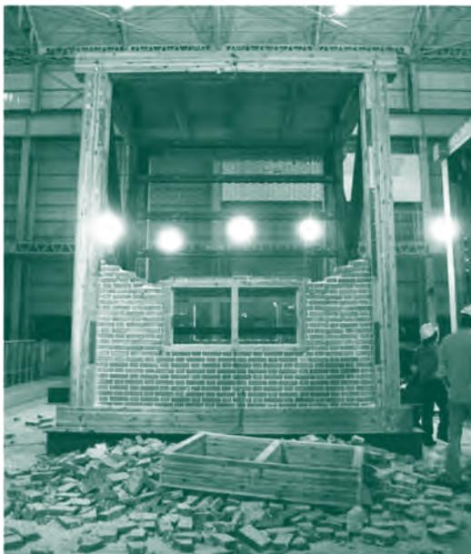
図4 富岡製糸場西繭置所の実大模型実験
