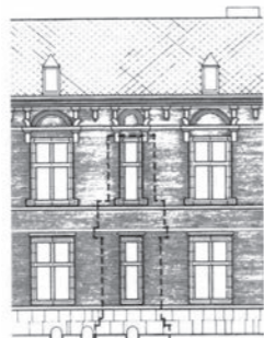
創建当初の推定復元図(破線は18世紀の改修部分) 4)
