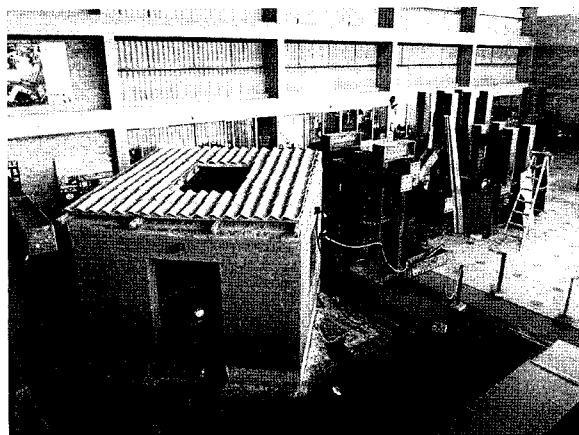
振動台上に設置された公開実験用アドベ造実大模型住宅
