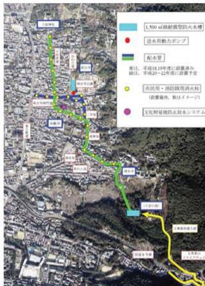
現在は、この図に示される範囲で工事が完了して運用が開始されています。清水寺から八坂神社の参道に至るまで、水道に頼らない防災水利が整備され、43基の市民消火栓が配備されている状況です。ただし事業はこれで完成ではなく、この南北の幹線から東西のエリアへと順次整備範囲を広げていく必要があります。
