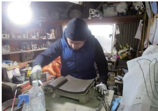
写真 2.2.14 補足する目板瓦製作の様子
